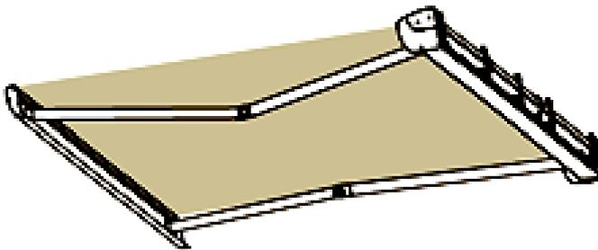
13) Vérifiez à l'aide d'un niveau si les bras se plient dans le même plan.
