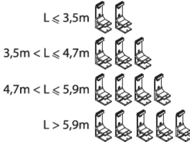
Il est recommandé d'installer les supports muraux extrêmes à une distance de 20 à 45 cm des extrémités du store, le reste doit être placé à intervalles réguliers.
