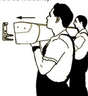
11) Fixez la poutre de structure du store avec des vis M8x65 puis fixez le couvercle en PVC.
