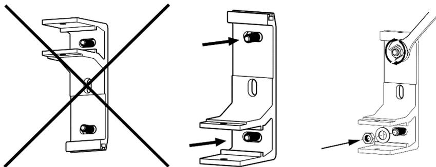
6) Sur la base du support mural monté (base), déterminez les points de fixation d'autres supports - faites particulièrement attention à ce que les supports muraux montés soient dans un même niveau et dans un même plan.
